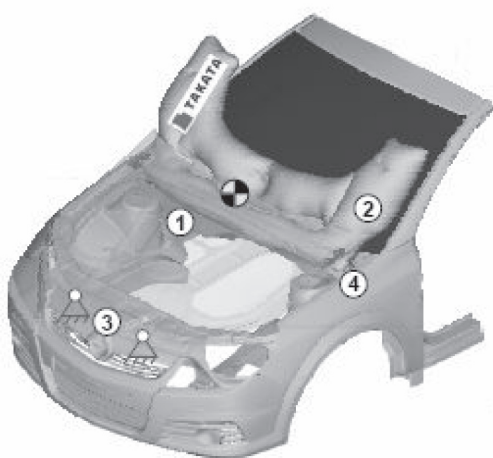
Slika 7. Vazdušni jastuk za zaštitu pešaka
