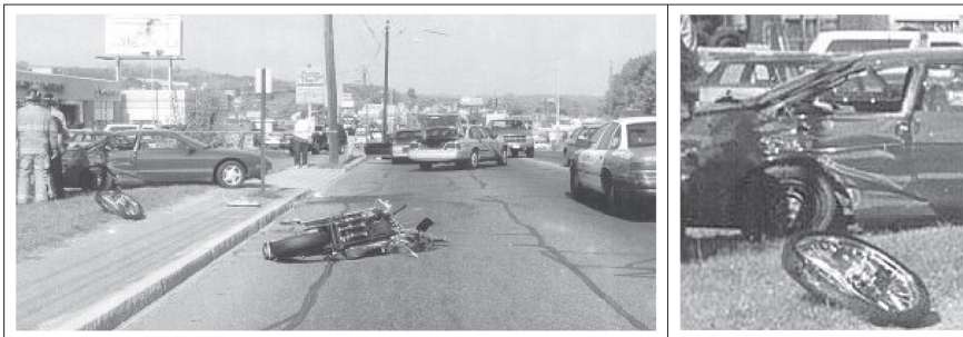
Slika 4. Zaustavne pozicije vozila i oštećenja na automobilu [3]
