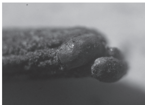
Sl.9 Bliži izgled zatopljenog kabla, u vidu kuglice-perle
