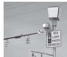
Sl.15. Kamera snima prolaz vozila na crveno svetlo semafora
